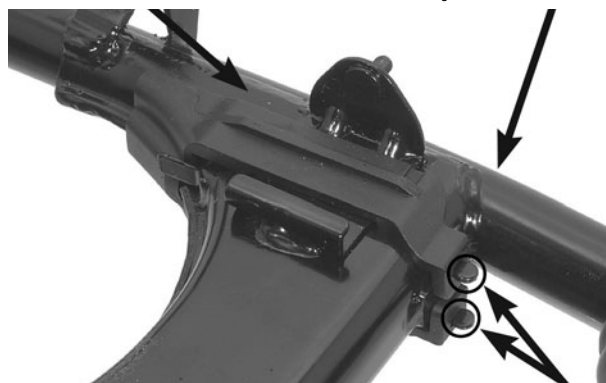
RANHURAS/ENCAIXES PORCA/ARRUELA/ARRUELA DA MOLA/PARAFUSO
