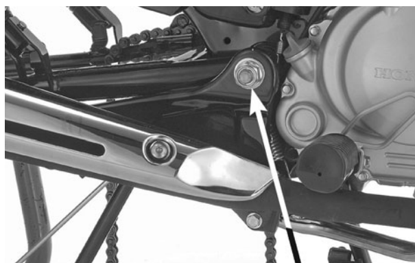
PORCA DA ARTICULAÇÃO DO BRAÇO OSCILANTE PARAFUSO DA ARTICULAÇÃO DO BRAÇO OSCILANTE
